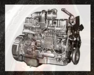
El motor Maxidyne se introdujo en 1967 y proporcionó la máxima potencia en un rango más amplio de velocidades que cualquier otro motor diésel estándar de su época. El diseño de los motores nivela la curva de potencia y, como resultado, aumenta la eficiencia de combustible y reduce significativamente la necesidad de cambio. Fue una meiora tal que una transmisión con cinco velocidades, en lugar de diez o más, se podría utilizar para la mayoría de las aplicaciones de carretera.
